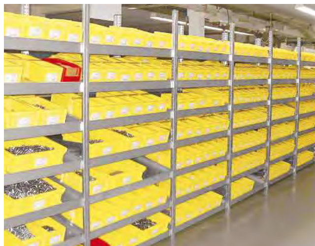
Bereitstellregale: Die Regale können von hinten bestückt werden. Selbsttätiges Gleiten der Behälter durch das Schwerkraftprinzip.
